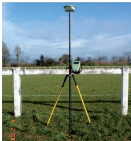
**Figure 3.** Exemple d'installation d'un récepteur GNSS en mode statique.
